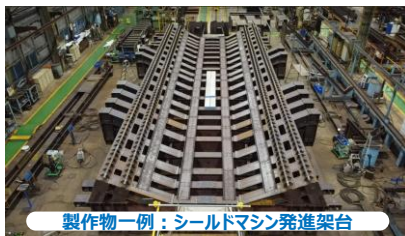
製作物一例：シールドマシン発進架台
