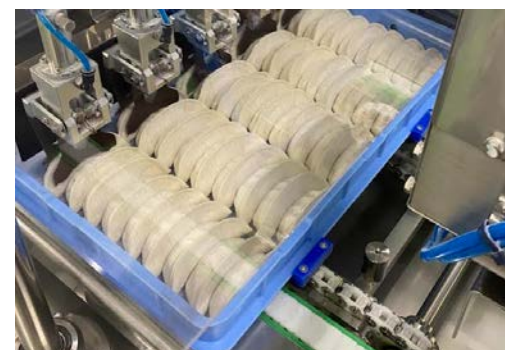
餃子をパレットに詰める工程を完全自動化
