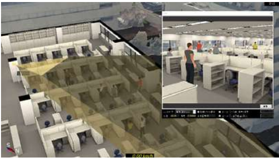
3次元建物情報とシミュレーション技術を用い監視カメラの最適な設置計画を立案
