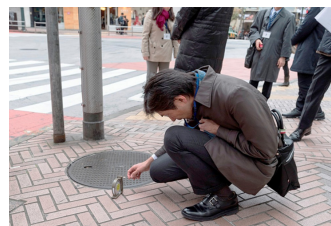
歩行空間におけるバリア情報(傾斜や段差、幅員等)を測定する様子
