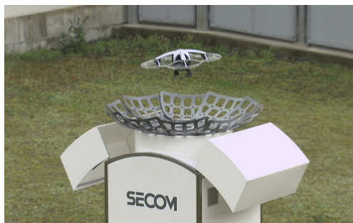
自律型飛行監視ロボット「セコムドローン」
