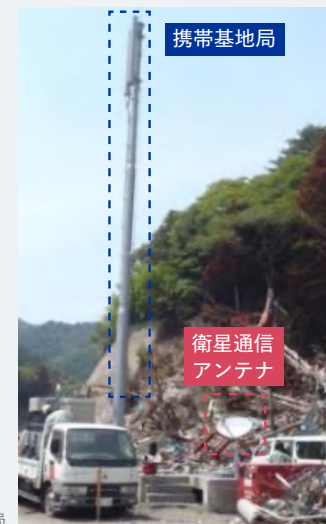
災害現場の携帯移動基地局
