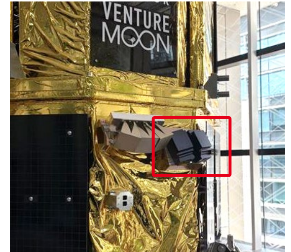
上記写真 赤枠がLRF。ランダーの側面に設置されている
