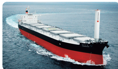
ローターセイル搭載石炭専用船 YODOHIME 84,961DWT
