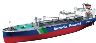
アンモニア燃料アンモニア輸送船 CGイメージ図
