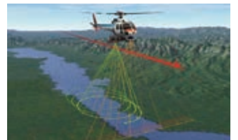
ヘリコプターによるレーザー測量イメージ
