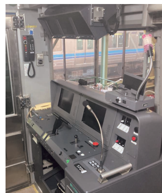
自動運転設備搭載の運転台
