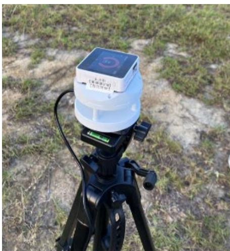
計測技術実証に使用した超音波風速計
