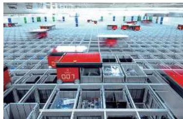
ロボットストレージシステム
