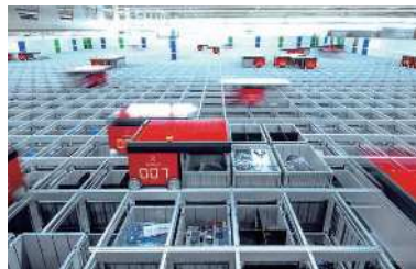
ロボットストレージシステム
