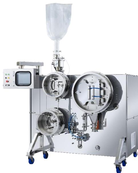
コンテインメント装置シリーズ『HUGO（ユーゴ）』は、アイソレータに代表される封じ込め技術を応用し、粉体機械単体で高度な封じ込め性能を実現。
