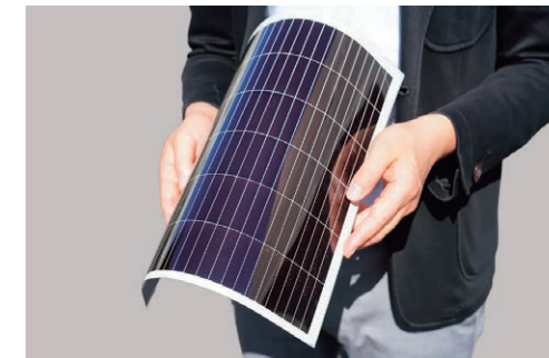
インクジェット印刷ペロブスカイト太陽電池
