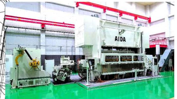
長野第9工場に設備された世界最大級高速プレス機
