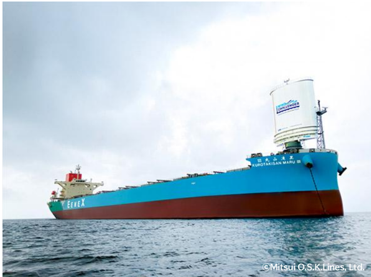
ウインドチャレンジャー搭載船「黒滝山丸Ⅲ」(左) と搭載された硬翼帆(右) 及び当社ロゴ位置(赤矢印)
