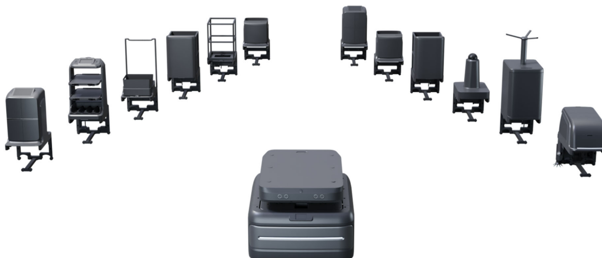
多機能サービスロボット RPX-100 と用途に応じた多様な上部ユニット
