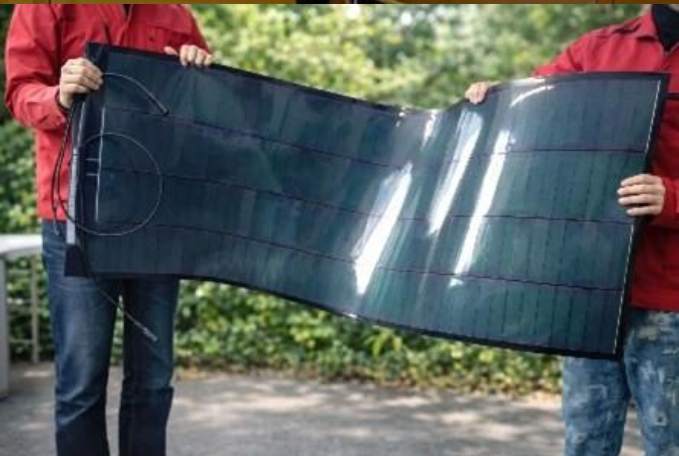
写真上：設置工事の様子 写真左：カルコパイライト型太陽電池（提供：株式会社PXP）
