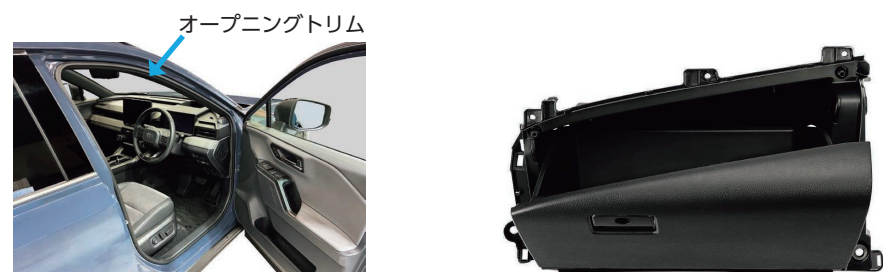
ゴムのリサイクル材を高配合したオープニングトリム 再生プラスチックを使用したグラブボックス
