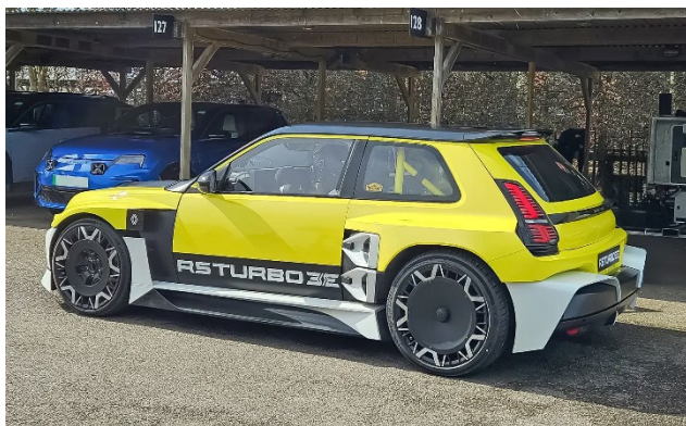
Protean 社のインホイールモータが搭載される Renault 5 Turbo 3E
