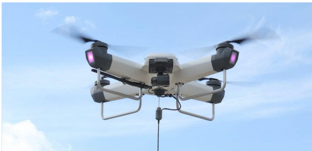
AileLinX（エールリンクス）が開発した製品の一つである、定点監視ロボット「HOVER EYE」
