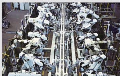
▲組立溶接設備
