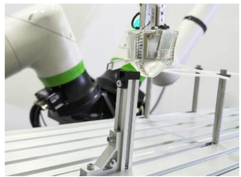
柔らかケーブル配線
