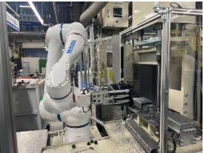
コンプレッサ機能破壊装置工程
