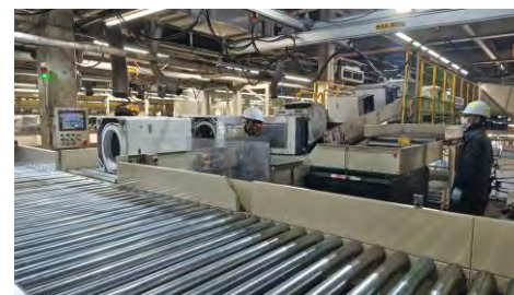
洗濯機搬送ライン
