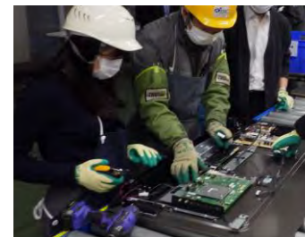
解体実習の様子
