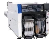
プロセスオートメーション (電子部品実装機 NPM-GW)
