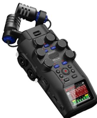
株式会社ズームは、EIN-127dBu の超低ノイズプリアンプ 4 基と 19.4mm 大口径 XY ステレオマイクを搭載した、スタジオ品質の 32bit フロート対応ハンディレコーダー『H6studio』を、2025 年 8 月下旬に発売します。
