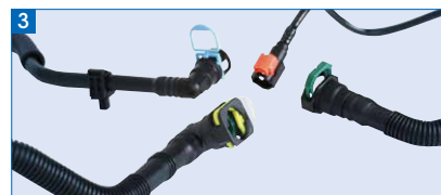
樹脂燃料配管
