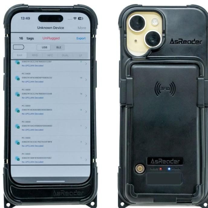
当社は、このたび、スマートフォンに装着して使用するカバーケース型UHF帯RFIDリーダー「ASR-M30S」を2025年10月より発売開始することを発表いたします。同時に、同リーダーと専用アプリを用いて、破損したRFIDタグを効率的に発見する新しいソリューション「FIND AsCode(ファインドアズコード)」の提供を開始します。
