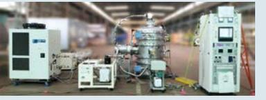
液化水素タンク底部真空排気実証実験装置
