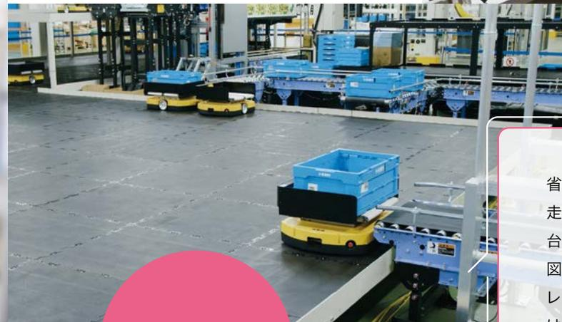
省スペースでの仕分けを実現するAMR(自律走行搬送ロボット)は、物量の変動に応じた台数の柔軟な増減など、システムの最適化を図ることができるのが特長です。このようなフレキシブルな特性が評価され、2024年度には大手EC企業様へ納入が実現しました。仕分け先の多いEC物流センターにおいて、効率的な運用が期待されるシステムです。
