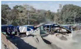
自走式破碎機 ジョークラッシャー MC110i&インパクトクラッシャー MR110i(KLEEMANN社製) 世界トップクラスの破碎性能と世界一の低燃費を実現 写真:コンクリート廃材の中間処理施設での納入事例
