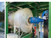
水素専焼でのアスファルト混合物の製造 及び試験施工を実施(2023年)
