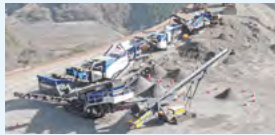
自走式破碎機、スクリーンの組み合わせ 既存定置式破碎プラントを自走式へ変更する設備投資ニーズが世界的にも増加しています。 写真:実機を連結し、デモ展示会を愛媛県の碎石場で開催
