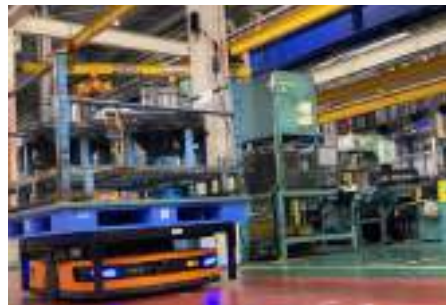
AGVによる自動搬送
