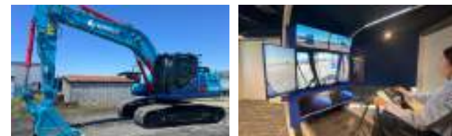
株式会社廣瀬で保有するシステム対応の油圧ショベル(左)と同社に提供したSmart Construction Teleoperationのコックピット(右)
