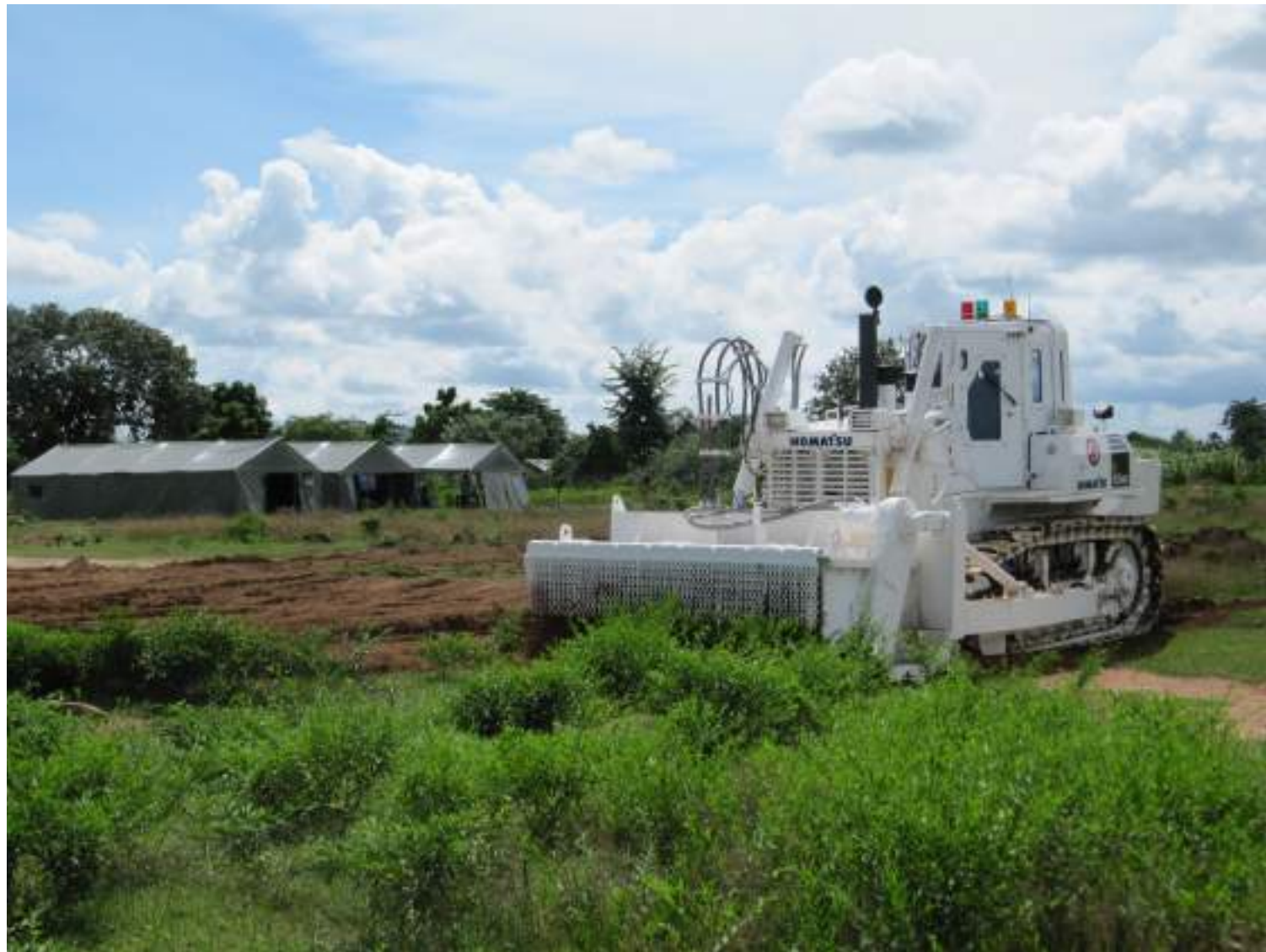
カンボジアで稼働中の対人地雷除去機「D85MS-15」
