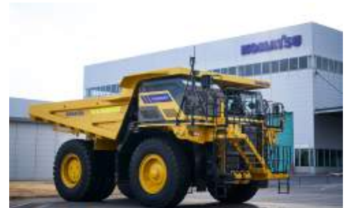
水素専焼エンジンを搭載した大型ダンプトラックのコンセプトマシン
