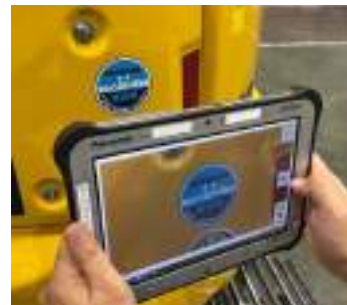
排ガス規制のデカールを AI が画像認識し自動検査
