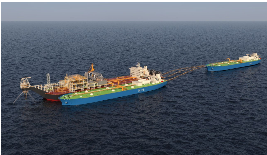
LCO 2 FSIU（二隻の LCO 2 輸送船からの同時積み込みのイメージ図）
