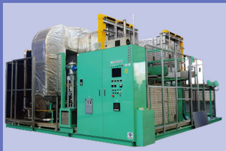
加熱設備（アルミ熱処理炉）の一例
