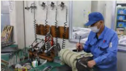
ポンプオーバーホールの様子
