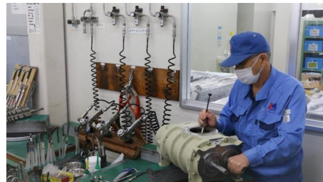
ポンプオーバーホールの様子
