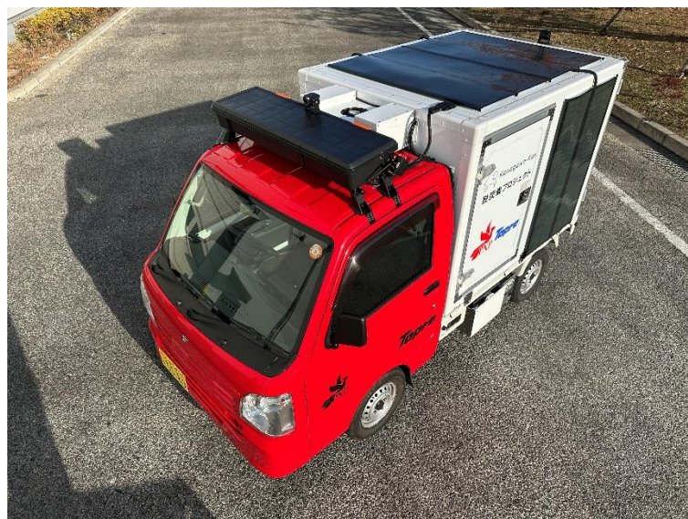
カルコパイライト型太陽光パネルを搭載した 低温物流車の試作車
