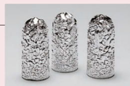
医療用生体内溶解性 高純度マグネシウム材料 (製品化に向けた取り組みを推進中)
