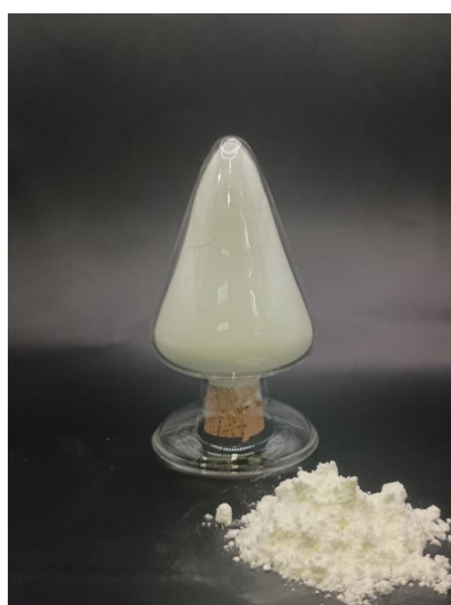
図 1. MOF 不要物（廃棄物）から合成した MOF の一例
