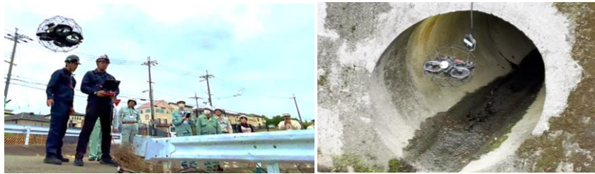
大阪府富田林市での技術検証の様子（左）と管渠に進入するELIOS 3（右）
