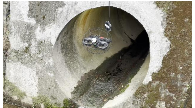
大阪府富田林市にて ELIOS 3 を活用した下水道点検技術 管渠に進入する ELIOS 3 の検証
