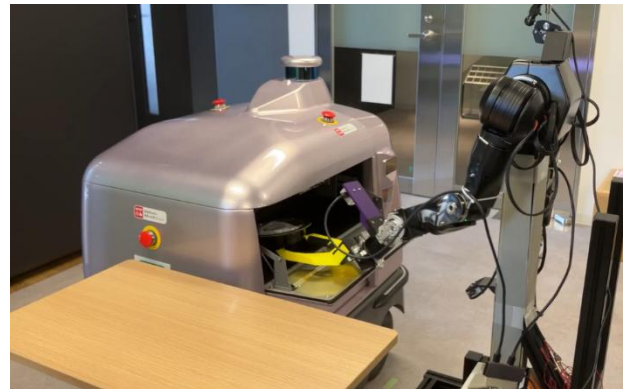
双腕ロボット（写真右）が卓上に置かれた対象物を把持し、デリバリーロボット（写真左）の棚に入れる様子
