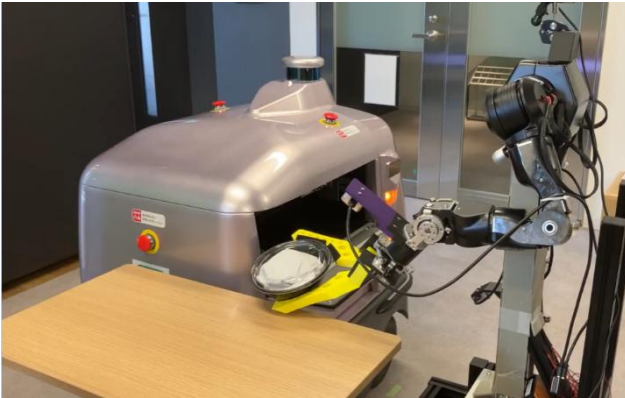
双腕ロボット（写真右）が卓上に置かれた対象物を把持し、デリバリーロボット（写真左）の棚に入れる様子
