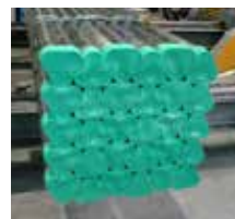
鋼製電線管の管端に装着したキャップ(緑色)
