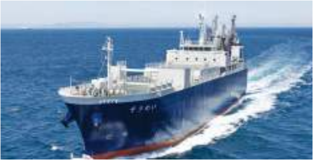
【高効率化】・ロールトレーラー(積載重量60t)を採用し、重量物輸送を実現 ・二層式の貨物構造化→大型エレベーター(210t/回)を配備
