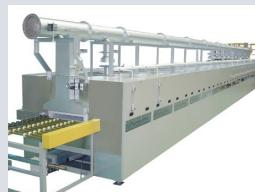
リチウムイオン電池用焼成炉
