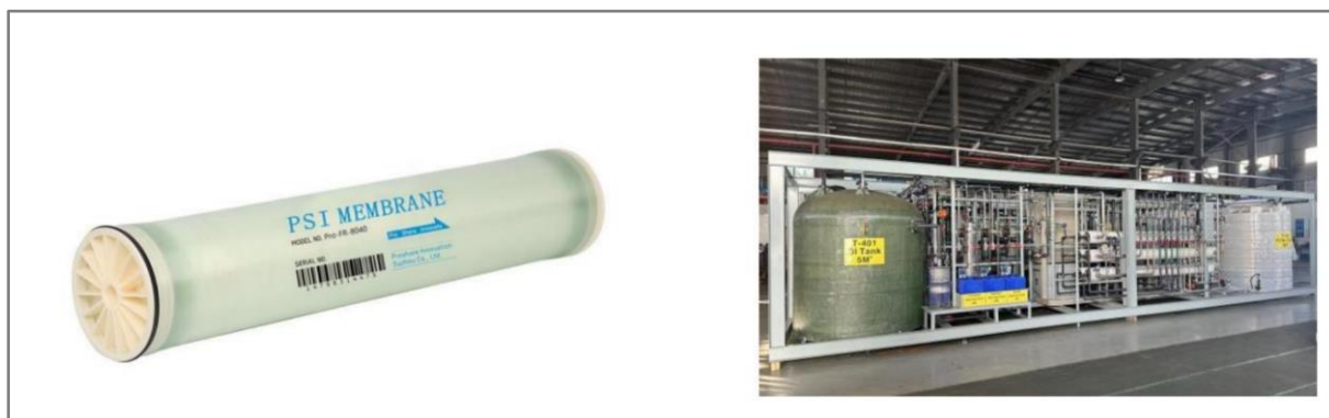
【Proshare 社の逆浸透膜（RO 膜）エレメント】（左）と【当社花泉工場に導入した Proshare 社製の逆浸透膜（RO 膜）を装填した超純水生成装置】（右）
