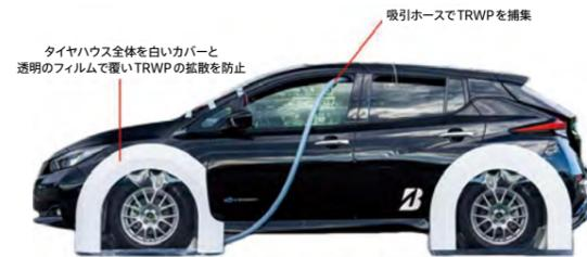
TRWPを捕集する装置を自動運転車に装着した様子
