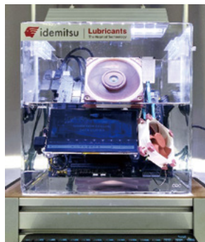
データセンター向け液浸冷却油「IDEMITSU ICFシリーズ」の試験機。様々な潤滑油開発で培った技術知見を活かし、高い安全性と冷却性能を両立。次世代データセンターの省エネルギー化に貢献
