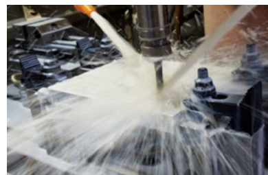
水で希釈した水溶性切削油を噴射して金属に高速穴あけドリル加工の様子。切削油の基本用途は工具の潤滑・冷却や機械の防錆・洗浄など。最適な油剤の処方設計が加工現場の生産性向上や作業環境改善に寄与
